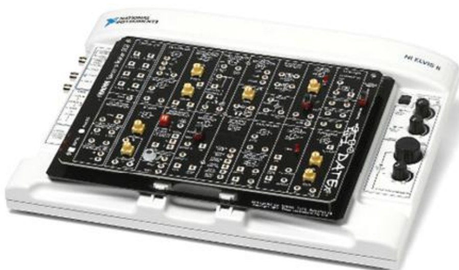
Рисунок 2 Лабораторный модуль «Радиотехника, электроника и телекоммуникации» - плата Emona DATEx
