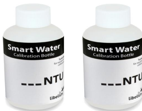
Рисунок 4 Набор для калибровки мутности
