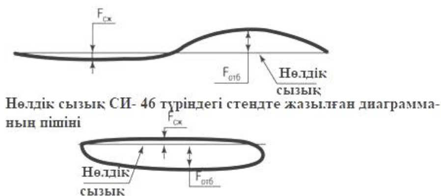
Сурет 1 Стендтегі демонтаждалған амортизаторды тексеру
